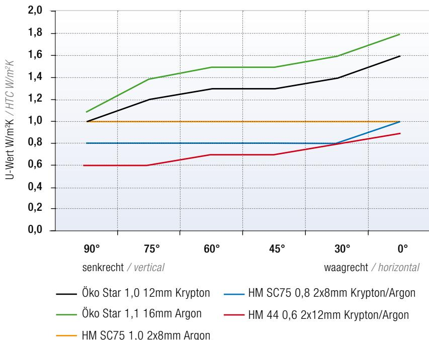
U-Werte berechnet nach EN 673 / HTC calculated according to EN 673
