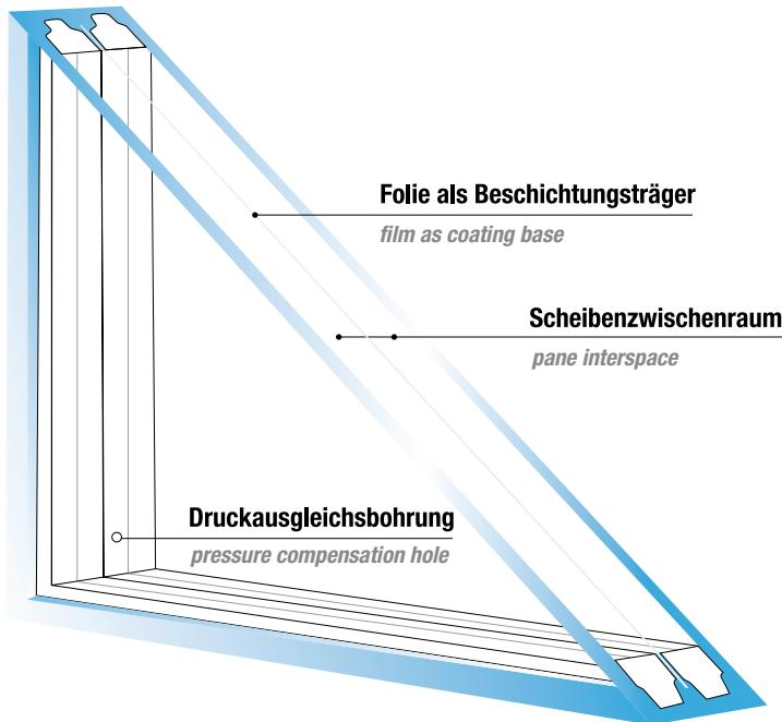
Das sichtbare Sonnenlicht zwischen 380 und 780 nm muss nahezu ungefiltert durch Fassadenglas durchstrahlen können, um das Gebäudeinnere mit natürlichem Licht zu versorgen; die für die Wärmeentwicklung verantwortliche Infrarotstrahlung zwischen 780 und 2.500 nm hingegen soll weitgehend ausgefiltert werden, um die übermäßige Aufheizung der Räume zu verhindern.
